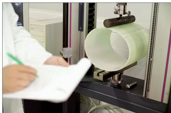
Fig. 5 -La conoscenza delle caratteristiche meccaniche dei liner, che viene desunta sulla base di prove standardizzate ai sensi delle normative europee ed americane, costituisce l'elemento fondamentale ed imprescindibile per il progetto del nuovo tubo, che molto spesso deve ripristinare tutte le funzioni perse dal tubo ospite, inclusa la portanza strutturale
