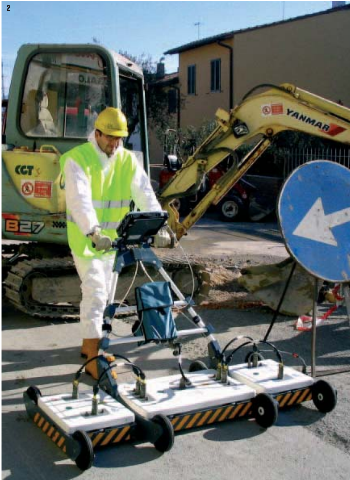
2. Un sistema radar RIS2k/MF per la detezone e mappatura di servizi interrati (per gentile concessione della IDS Spa)
