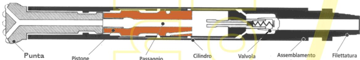
Fig. 2 – Sezione schematica di un martello pneumatico fondo foro.
