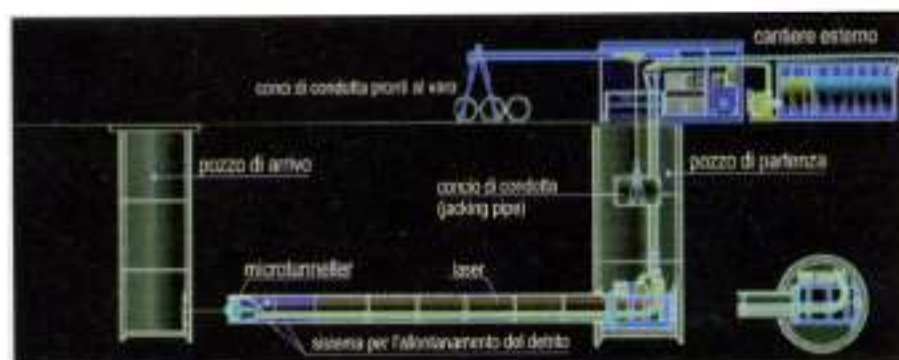
FIG. 4 - Tipico cantiere da microtunnelling.
