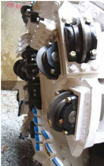
Testa di perforazione da terreno misto
